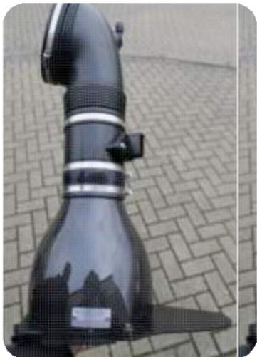
13. Installieren Sie das originale Verbindungsstück am Alu Verbindungsrohr. Ziehen Sie die Schellen nur leicht an.
