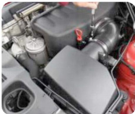
1. Beide Schellen zwischen Airbox und Luftfilterkasten lösen.
