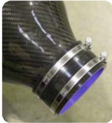
10. Installieren Sie den Silikonschlauch auf dem Carbon Filtergehäuse.
