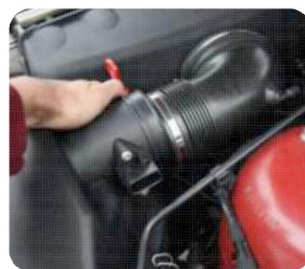
4. Lösen Sie den Luftfilterkasten vom Anschluss.
