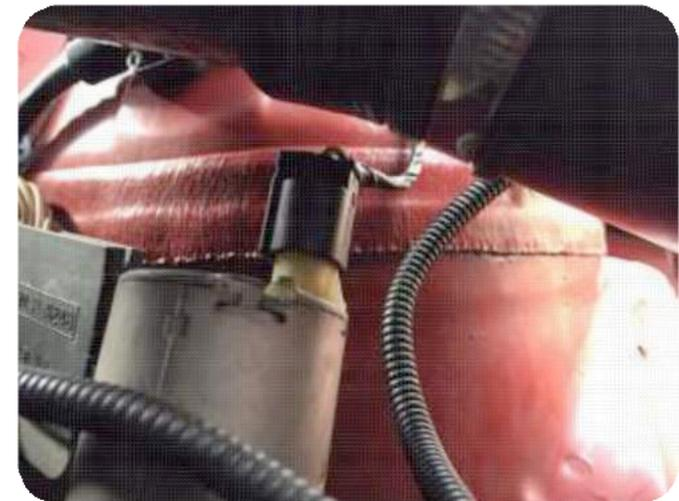
16. Verbinden Sie das Verbindungsrohr mit der Airbox. Achten Sie auf genügend Freiraum für den Anschluss der Wasserpumpe.
