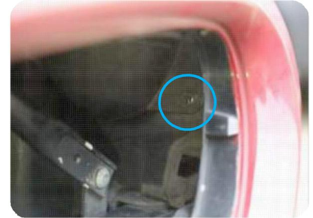
20. Entfernen Sie die Luftführung. Zuerst die Kunststoffspreiznieten im Bild gekennzeichnet. Ziehen Sie die Luftführung nun raus, Sie wird auf der Rückseite von zwei Nasen gehalten, siehe nächstes Foto.
