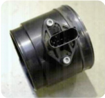
9. Installieren Sie den Luftmassenmesser am Verbindungsrohr. Achten Sie auf die korrekte Richtung des Sensor und nutzen Sie die beiliegenden Schrauben zur Befestigung.
