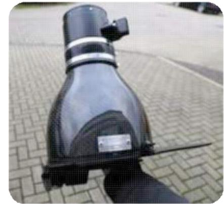
12. Setzen Sie das Verbindungsrohr in den Silikonschlauch ein und achten auf einen die Position des Luftmassenmesser wie auf dem Bild gezeigt.
