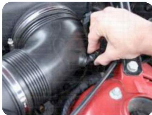
2. Entfernen Sie die Entlüftungsleitung durch eindrücken der Klammer. Lösen Sie die Leitung am Luftfilterkasten.
