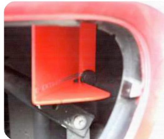
23. Nutzen Sie die beiliegenden Spreiznieten zur Befestigung. Installieren Sie die Niere.
