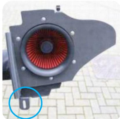
14. Die Halterung am Hitzeschild muss wie in Schritt 7 genannt aufgesetzt werden.
