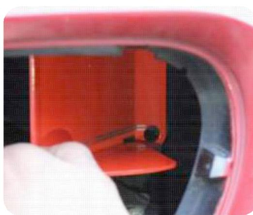
22. Führen Sie das neue Scoop ein, es wird über den ursprünglichen Halterung der Luftführung montiert.
